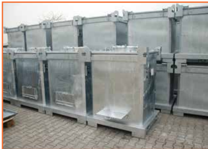
Sonderabfall-Behälter 152-156 (für flüssige Stoffe)
